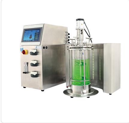
BioCore QPF光照植物细胞发酵系统是一款功能强大的发酵系统，采用PLC控制，集成控制PH、DO、温度、二氧化碳、液位、转速，通过金属蚀刻加热片和内置的冷却管控制温度，驱动WASTON-MA-RLOW 蠕动泵进行培养基的添加和PH、泡沫等的控制。可以满足实验室规模的发酵产品的工艺条件优化、菌种筛选、小样制备。
