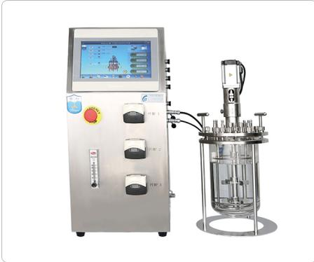
BioCore QF发酵系统是一款功能强大的发酵系统，采用PLC控制，集成控制PH、DO、温度、液位、转速，通过金属蚀刻加热片和内置的冷却管控制温度，驱动WATSON-MARLOW蠕动泵进行培养基的添加和PH、泡沫等的控制。可以满足实验室规模的发酵产品的工艺条件优化、菌种筛选、小样制备。
